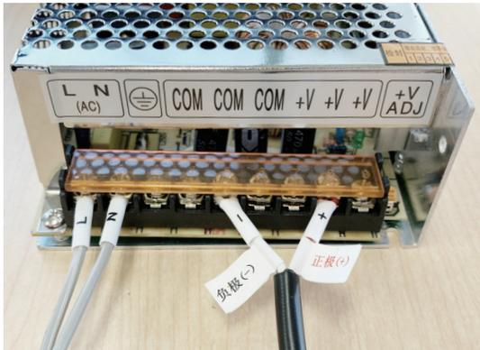
※プラス(+)とマイナス(-)に十分注意して接続してください。間違えますと破損の原因になります。
