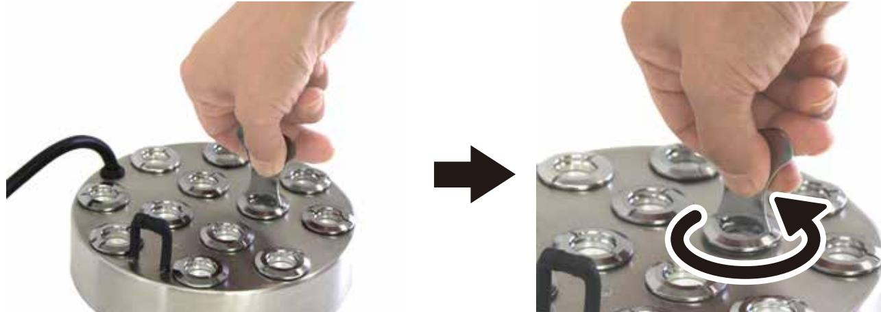
工具をリング溝に差し込み、**左回し**でリングを緩めます
