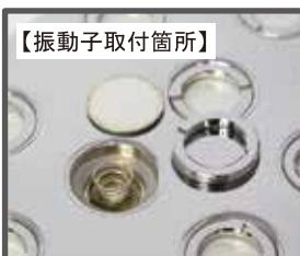
振動子を交換後、リングをはめて右回しでねじを緩めます
