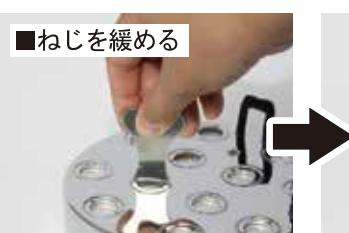
工具をリング溝に差し込み、左回しでねじを緩めます
